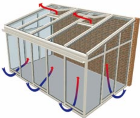
Wentylacja przez okna dachowe
